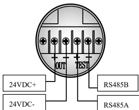
信号端子设置在电气盒的独立舱内。在接线时，可拧下接线侧的表盖。电源是通过信号线接到变送器的，不需要另外的接线。
